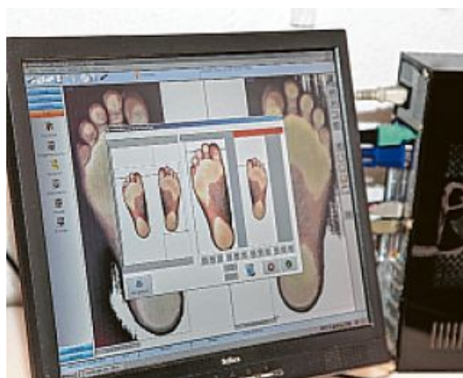
Die 3D-Fußvermessung ermöglicht das Maßnehmen in digitaler Form. Ein Abdruck aus Kunststoffgips unterstützt.
